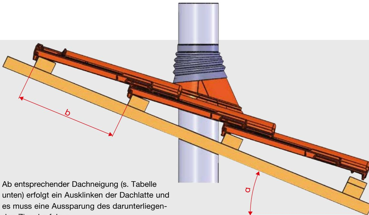
Ab entsprechender Dachneigung (s. Tabelle unten) erfolgt ein Ausklinken der Dachlatte und es muss eine Aussparung des darunterliegenden Ziegel erfolgen.
