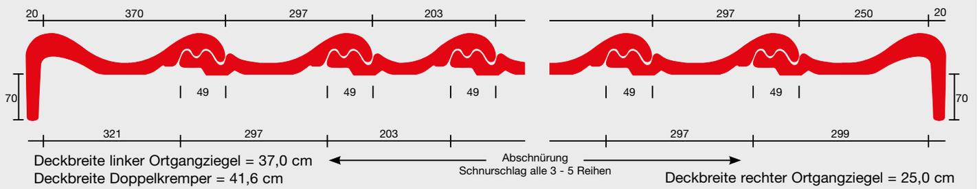
Einlattung der Dachfläche in Verbindung mit Firstrollen (Trocken-First)
