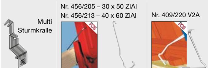
Entsprechend den Fachregeln liefern wir Sturmklammern für die einfache und effektive Windsogsicherung. Alternativ zum Verkleben mit der Lattung oder zum Einschlagen in die Lattung. Korrosionsbeständig durch Edelstahl (A2) oder ZIAL®-Beschichtung (Korrosionsschutz).
